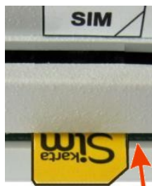
Rys. 11. Instalowanie karty SIM
