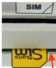
Rys. 11. Instalowanie karty SIM
