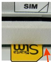
Rys. 11. Instalowanie karty SIM
